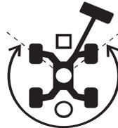
Pour déplacer la machine, déplacer l'interrupteur de validation de translation et sortir lentement la manette de contrôle de translation/direction de la position centrale.
