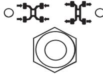
Les témoins d'extension et de rétraction des essieux clignotent lorsque les essieux bougent. Le témoin d'extension des essieux reste allumé lorsque les essieux sont complètement étendus. Le témoin de rétraction des essieux reste allumé lorsque les essieux sont complètement rétractés.
