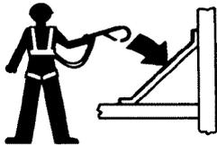
Les occupants de la nacelle doivent porter une sangle ou un harnais de sécurité, conformément aux réglementations officielles en vigueur. Attacher la longe de sécurité au point d'ancrage prévu à cet effet dans la nacelle.
