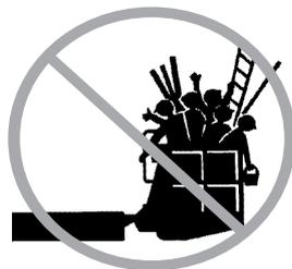
Ne pas placer d'échelle ni d'échafaudage dans la nacelle, ni contre une partie de la machine.
