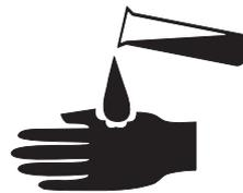
Les batteries contiennent de l'acide. Toujours porter des vêtements et des lunettes de protection pour travailler sur les batteries.
