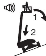
Si l'alarme de dévers retentit avec la nacelle relevée en montée :
