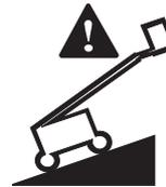
Si l'alarme de dévers retentit avec la nacelle relevée, le témoin de machine inclinée s'allume et la fonction de translation dans un sens ou les deux ne s'active pas. Déterminer la position de la flèche sur la pente, comme illustré ci-dessous. Abaisser la flèche conformément aux instructions avant de déplacer la machine sur une surface ferme et plane. Ne pas faire pivoter la flèche en l'abaissant.
