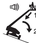
Si l'alarme de dévers retentit avec la nacelle relevée en descente :
