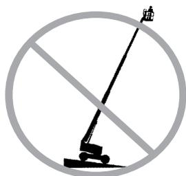
Ne pas se fier à l'alarme de dévers pour indiquer le niveau. L'alarme de dévers retentit dans la nacelle uniquement lorsque la machine se trouve sur une pente à forte inclinaison.
