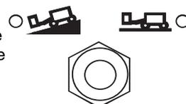
Symbole d'inclinaison de la machine : amplitude de fonctionnement réduite en pente.
