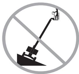
Ne pas relever ni étendre la flèche tant que la machine n'est pas sur une surface ferme et plane.
