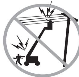
Rester éloigné de la machine si elle touche des lignes sous tension. Le personnel au sol ou à bord de la nacelle ne doit ni toucher, ni utiliser la machine tant que les lignes électriques sont sous tension.
