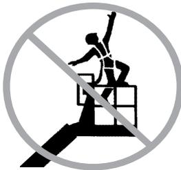
Ne pas s'asseoir, se tenir debout, ni monter sur les rampes de sécurité de la nacelle. Garder constamment les deux pieds fermement posés sur le plancher de la nacelle.
