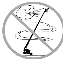
Ne pas relever la flèche lorsque la vitesse du vent peut dépasser 12,5 m/s. Si la vitesse du vent est supérieure à 12,5 m/s lorsque la flèche est relevée, abaisser la flèche et arrêter immédiatement la machine.
