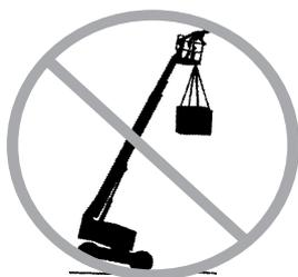
Ne pas placer ni attacher de charges fixes ou suspendues sur une partie de cette machine.
