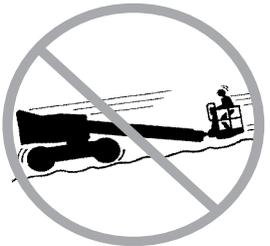
Adapter la vitesse de déplacement en fonction de l'état du sol, de la circulation, de l'inclinaison, de l'emplacement du personnel et de tout autre facteur susceptible de provoquer une collision.
