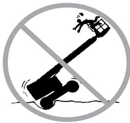
Faire preuve d'une extrême prudence et rouler lentement en conduisant la machine en position repliée sur un terrain irrégulier, des débris, des surfaces meubles ou glissantes ou près de trous et de dévers.
